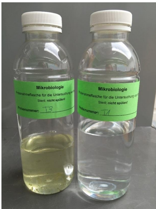
Abb. 7: Probenentnahmeflaschen - in der Abbildung mit Wasserproben und beschriftet mit Angaben zu den Proben (Bild: Annika Seiler).
