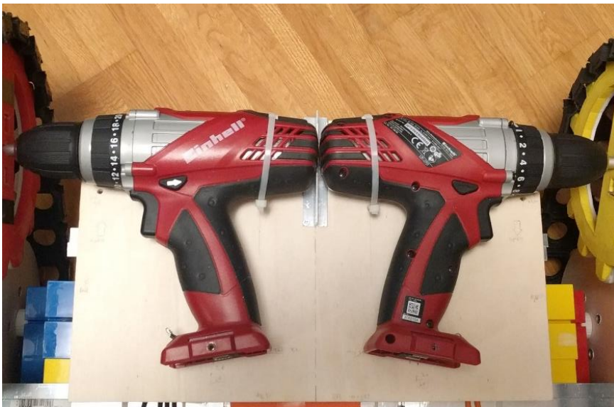
Abb. 23: Motormodul mit neuen Akkubohrern von Einhell
