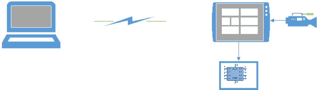
Abb. 1: Schema der Kommunikation. Links ein Laptop, rechts ein Tablet mit Kamera und unten ein Mikrocontroller
