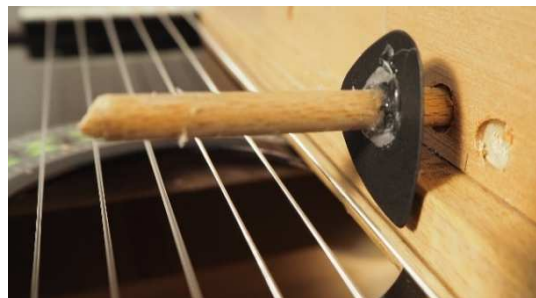
Abbildung 7: Das Plektrum dreht sich von der Saite weg, eigene Abbildung
