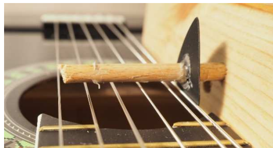
Abbildung 6: Das Plektrum drückt die Saite weg, eigene Abbildung
