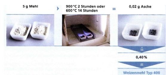
Abbildung 3: Berechnung des Ausmahlungsgrades
