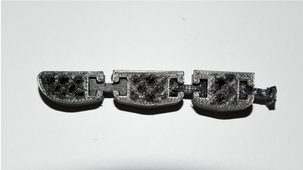
Abbildung 7 - Löcher, welche auf der Oberfläche bei einem zu kleinen Infill entstehen
