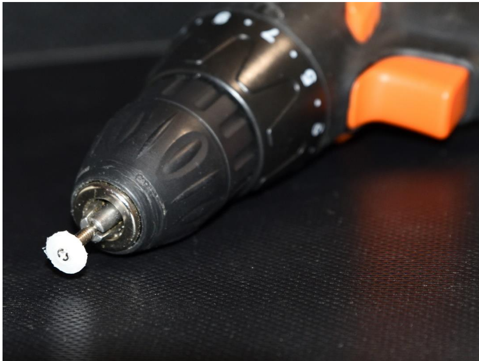
Abbildung 40 - Die Fadenspule ist an der Bohrmaschine fixiert, um geschliffen zu werden
