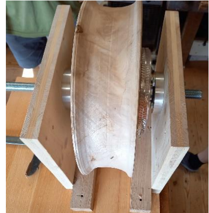
Abbildung 16: Antriebsrad mit Metallrad und Flansch mit Kugellager
