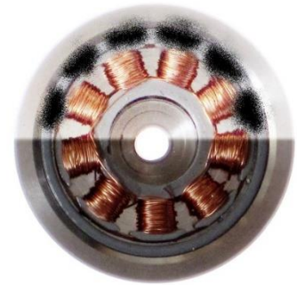
Abbildung 11: Bürstenloser Gleichstrommotor, Polarisierung des Rotors in Schwarz hervorgehoben
