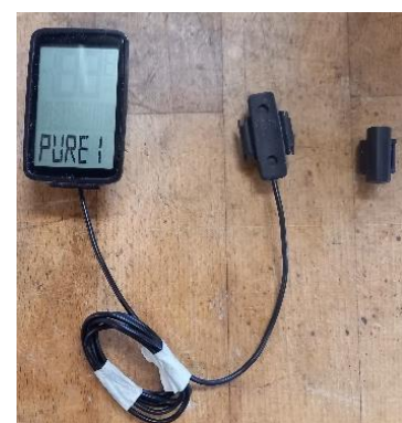
Abbildung 22: Fahrradcomputer, Bildschirm (l), Sensor (m), Magnet (r)
