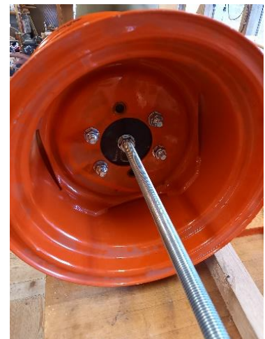
Abbildung 17: Bremsrad mit Metallplatte
