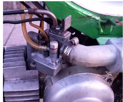
Abbildung 5: Vergaser mit Luftfilter (r) und Motor (l)
