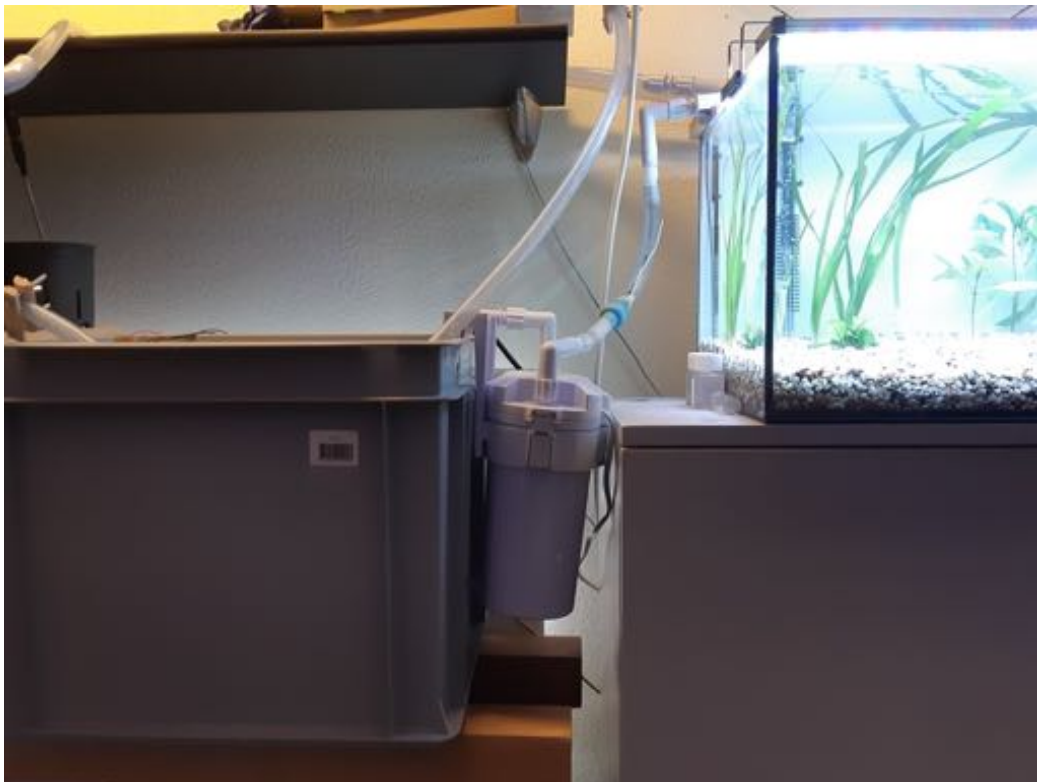
Abb. 20 Höhenunterschied vom Überlaufbecken (links) und dem Aquarium (rechts)
