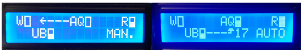
Abb. 16 Beispiele vom LCD-Display des Arduino mit verschiedenen Zuständen der Anlage. (W = Ebbe- und Flutsystem (Wanne), AQ = Aquarium, R = NFT-System (Regenrinne), UB = Überlaufbecken)
