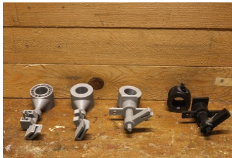
Abbildung 5.3: 4 Versionen eines Bauteil der Baugruppe Schacht
