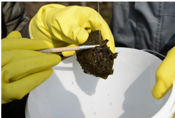
Abbildung 4: Methodik Probenahme Geröll; links oben: Stein anheben; rechts oben: Stein aus Netz nehmen; links unten: Stein abspritzen und pinseln; rechts unten: Stein in Eimer
