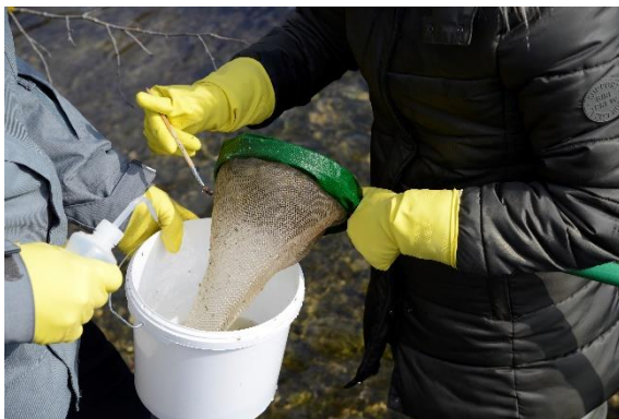
Abbildung 5: Methodik Probenahme Kies links: Netz mit Spritzflasche ausspülen; rechts: Probe in Plastikscha
