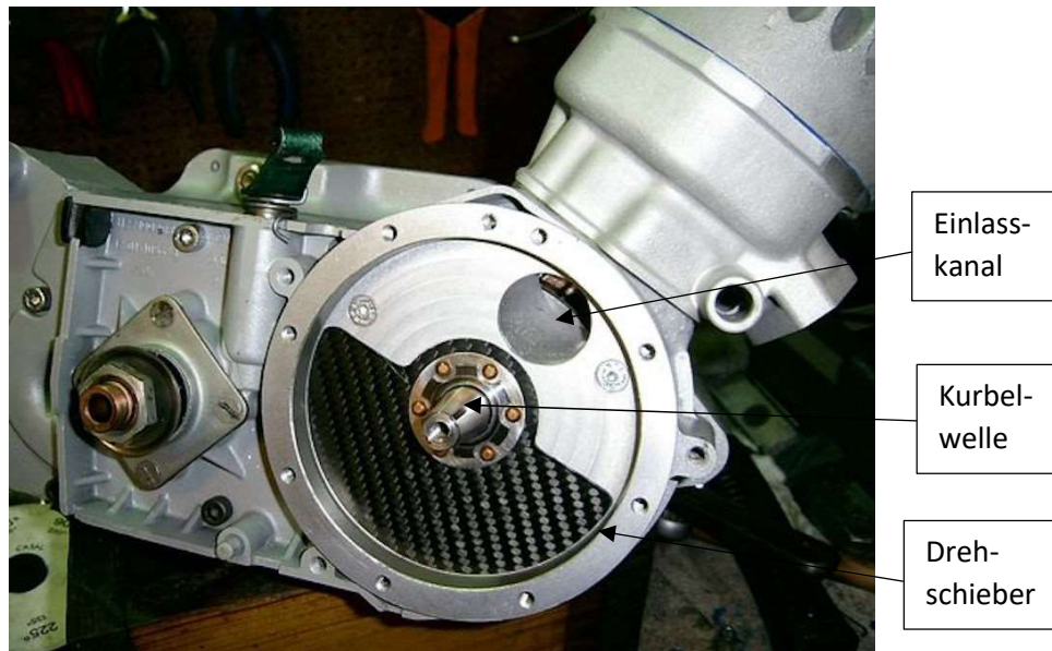
Abbildung 10: Simson Motor mit Carbon Flachdrehschieber
