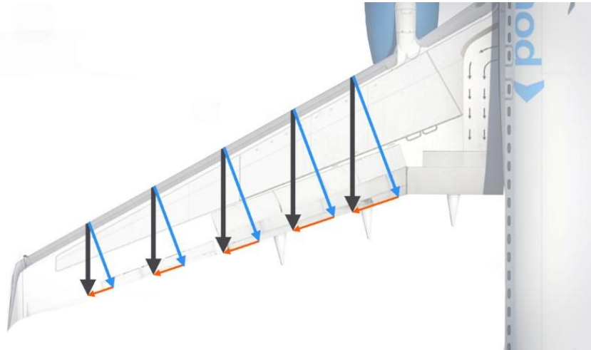
Abbildung 10: Aufteilung der Strömung bei gepfeiltem Flügel
