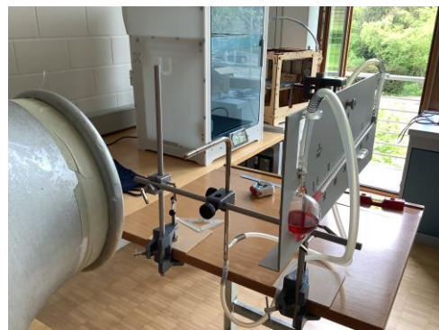
Abbildung 27: Messaufbau für die Messungen der Windgeschwindigkeiten
