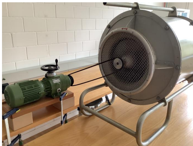
Abbildung 18: Einlass mit Elektromotor des Windkanals der KRW
